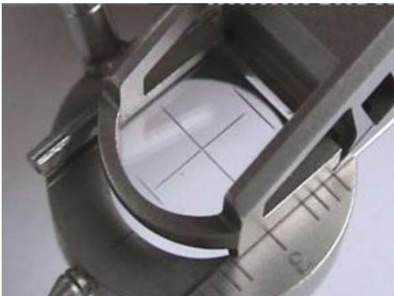
**Abb. 7.1 SKBM/Lasitom.** Prototyp eines linearen Mikrokeratoms mit vollständiger kornealer Applanation vor Schnittbeginn. Das Kreuz in dem durchsichtigen Applanationsplättchen ermöglicht eine optimale Zentrierung. Konstrukteur: Dr. H.J. Krumeich.
