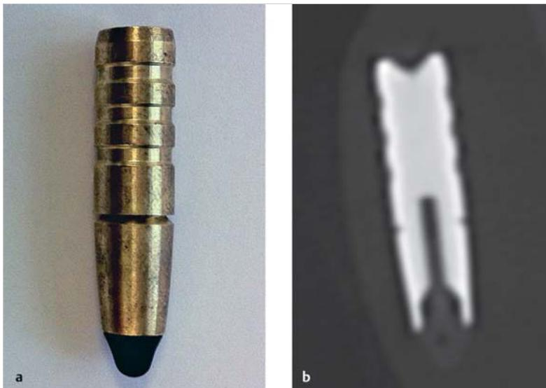
Abb. 11.6 Unverschossenes Teilmantelgeschoss mit Polymerspitze.
