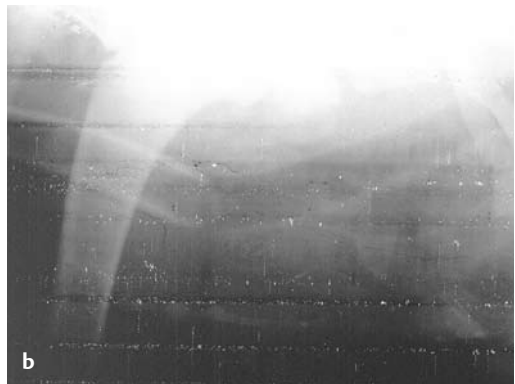
► Abb. 3.29 Artefakte bei maschineller Filmverarbeitung. a Ein Netz strichförmiger, weißer Bereiche über der Aufnahme: Beschädigung der Emulsion, z. B. bei nicht rotierender Walze. b Kratzer in der Emulsion und quer verlaufende schwarze Druckstreifen bei beschädigten Walzen.
