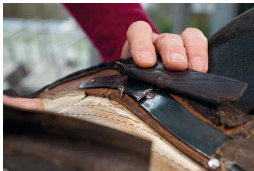
► Abb. 6.1 Sattel mit gebrochener Stahlfeder. (Quelle: Rainer Weppelmann, Dülmen)
