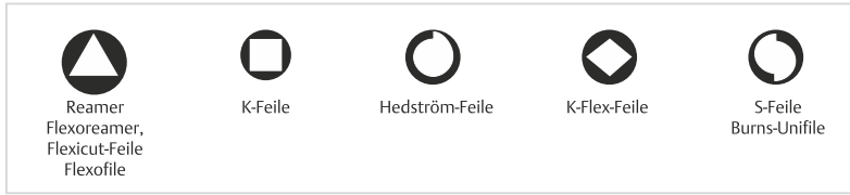
Abb. 13.16 Typische Querschnitte des Arbeits-teils endodontischer Handinstrumente.
