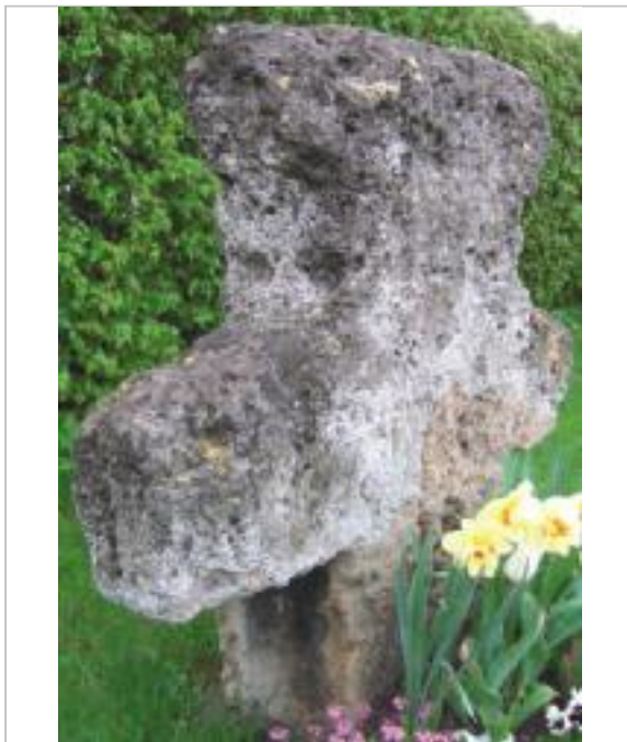
Abb. 12.10 Zerstörung von steinernen Skulpturen und Bauwerken. Tuffstein-Pestkreuz aus dem 17. Jahrhundert mit typischen Verwitterungsmerkmalen durch die Aktivität nitrifizierender Bakterien und Flechten. (Aufnahme Bernhard Heider, Bobingen)
