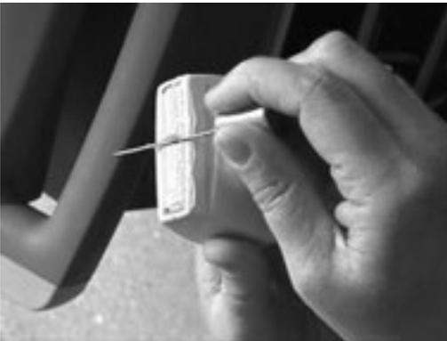
**Abb. 5.11** Test mit Metallstab am Schallkopf.
