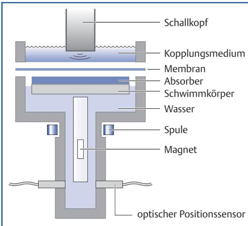
Abb. 5.9 Skizze zur Doptek-Strahlungswaage.
