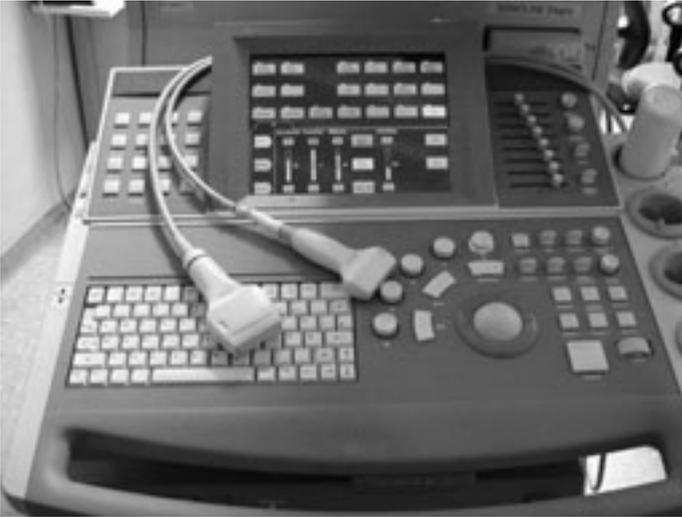
**Abb. 5.10** Ultraschallgerät. Der „5-min-Check“ beginnt mit der Inaugenscheinnahme des Gerätes, der Kabel und Kontakte sowie der Schallköpfe.
