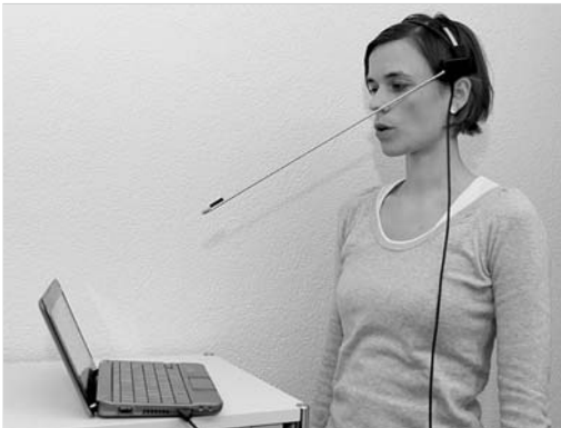
Abb. 6.6 Untersuchungssituation von akustischen Analysen. Aufnahme und Messung der Stimme mittels Computer. Verwendet wurde ein Kopfbügelmikrofon mit 30 cm Abstand zum Mund.
