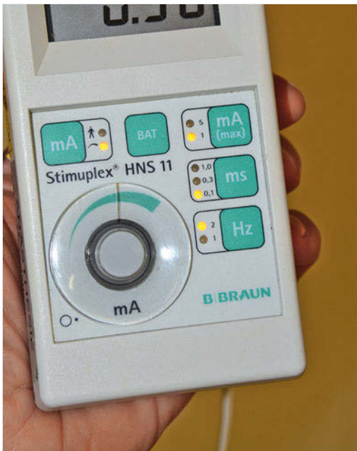
Abb. 2.6 Nervenstimulationsgerät Die zu empfehlen- den Einstellungen leuchten auf.
